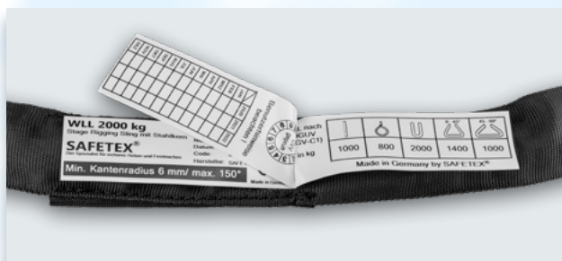
Étiquette de capacité de charge selon DGUV avec facteur de fixation. Étiquette supplémentaire pour le contrôle visuel annuel.
