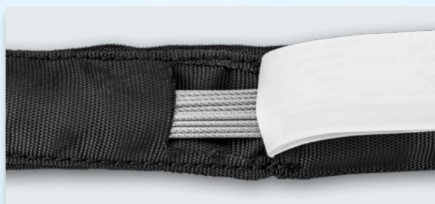
Fenêtre de contrôle pour vérifier l'insert de câble en acier sous les caches de protection verrouillables.
